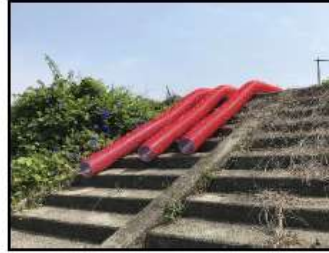
サクシヨンホースは耐圧・耐熱性と屈曲性がありながら、ホースの扁平が少ないため、ポンプ能力を低下させにくい
